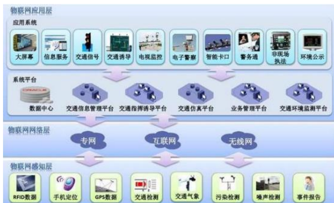
图 3-9 智能城市道路交通物联网架构
